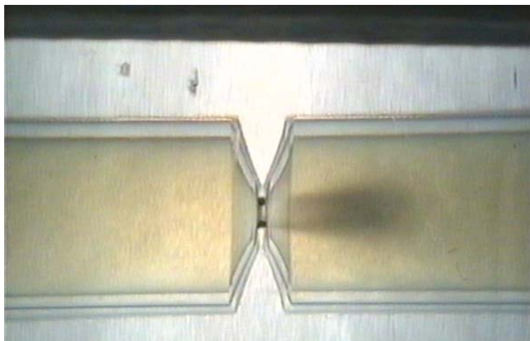
Рис. 2. Фотография дросселирующего устройства и развитие “факела” кавитационных пузырьков в приемной камере дросселирующего устройства
