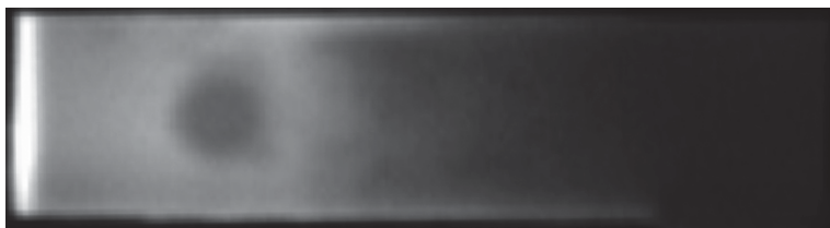
Рис. 2. Тепловизионное изображение температурного поля на поверхности пластины с дефектами
