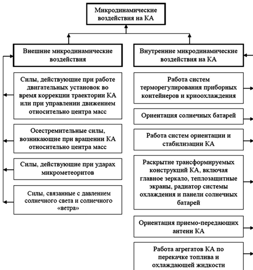
Рис. 6. Классификация ВВМВ на космический аппарат (КА) с орбитой в окрестности антисолнечной точки Лагранжа L2
