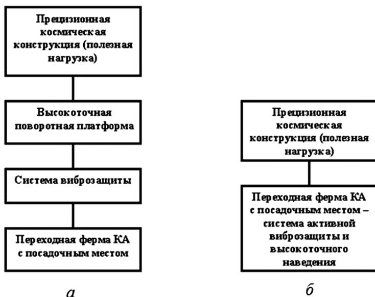
Рис. 10. Существующий (а) и новый (б) подходы к организации виброзащиты и высокоточного наведения прецизионной космической конструкции
