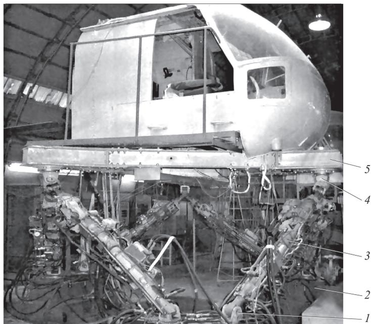
**Рис. 12. Общий вид шестистепенного динамического стенда авиационного тренажера — полномасштабной физической модели пространственной САВН КТ:**
