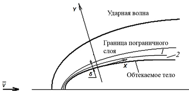
Рис. 1. Схематическая структура ударного слоя:
