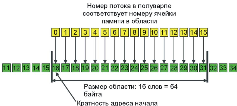
**Рис. 2. Условия обеспечения связывания при работе с глобальной памятью**
