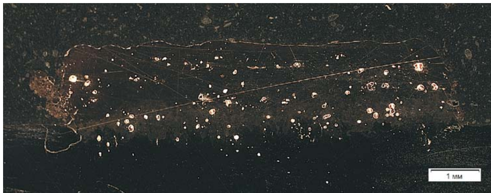
Рис. 5. Микроструктура образца, выращенного из окисленного порошка ПР-БрХ, при удельной мощности 360 Дж/мм 3 ; ×12, темное поле
