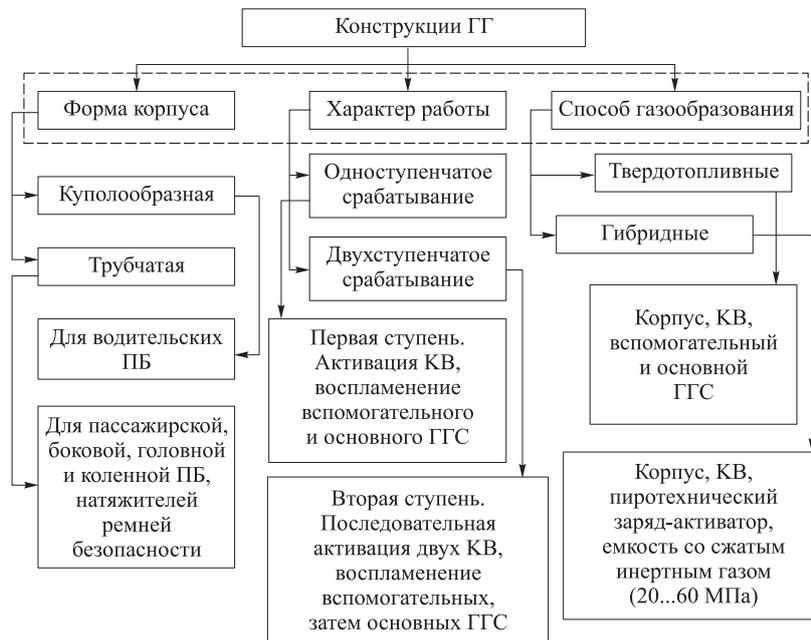
Рис. 1. Классификация конструкций ГГ
