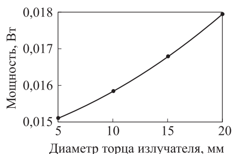
Рис. 7. Зависимость приходящейся на ультразвуковой излучатель мощности от диаметра его торца
