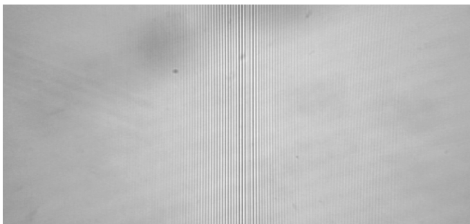
Рис. 5. Фрагмент интерференционной картины вторичного излучения антрацена при возбуждении излучением светодиода ( \lambda = 365 нм)
