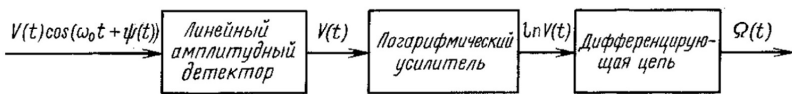
Рис. 2. Структурная схема измерения логарифмической производной огибающей суммы гармонического сигнала и квазигармонического шума
