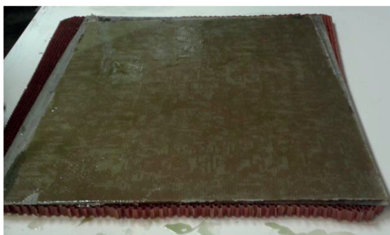
Рис. 5. Панель ТСК на этапе сборки обшивок и сотового наполнителя перед вакуумированием
