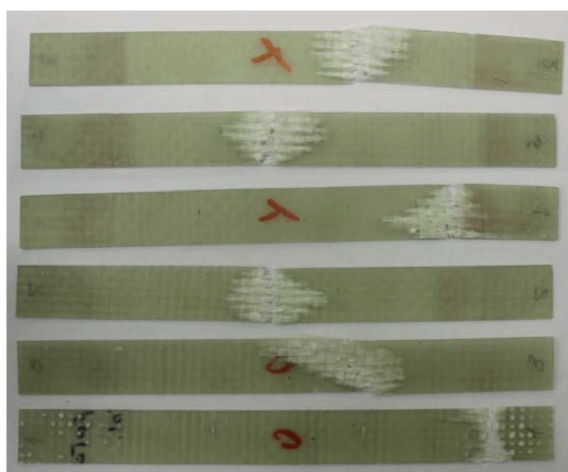
Рис. 3. Образцы стеклопластиковых обшивок после испытаний на растяжение
