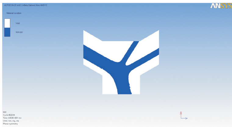
Рис. 2. Соударение двух плоских струй при \alpha = 60^\circ и k = 0,5 при нестационарной ( a , t = 10 мс) и стационарной ( б , t = 25 мс) стадиях
