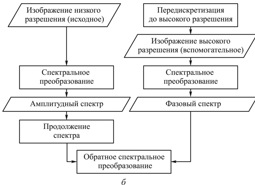
Рис. 1. Схемы методов пространственно-спектрального синтеза с привлечением опорного оптического изображения (а) и синтеза спектров с интерполяцией данных (б)
