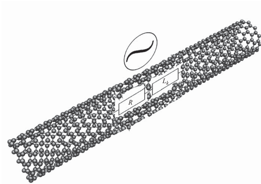
Рис. 1. Схема, иллюстрирующая эквивалентность углеродной нанотрубки активному двухполюснику
